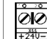
Figura 9: morsetti uscita ausiliaria
