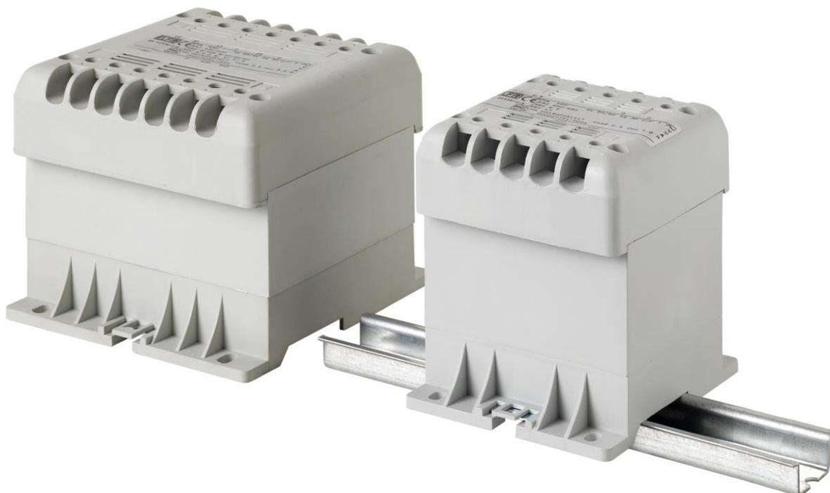
I trasformatori della serie TES-TET sono costruiti in classe II, secondo la norma IEC EN 61558-1. La protezione contro i contatti diretti ed indiretti si basa sul doppio isolamento. Un'applicazione tipica è su impianti che non dispongono della terra di protezione.
